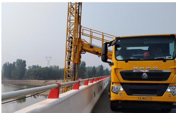
图：对廊霸线苑家务大桥进行检测
